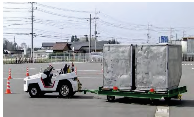
<写真 左：成田航空ビジネス専門学校 グランドハンドリングコース実習場 / 右：トーイングトラクターとコンテナを搭載したパレットドローリー> 写真提供：成田航空ビジネス専門学校
