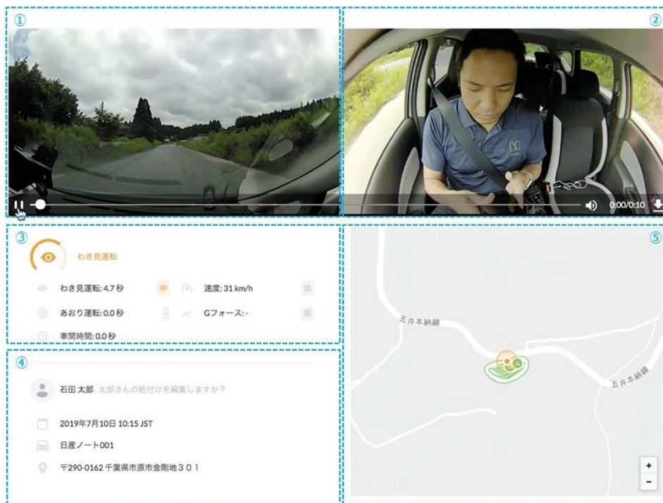
①車外カメラ画像、②車内カメラ画像、③発生したリスク、 ④ドライバー情報、発生地点情報、⑤発生地点地図
